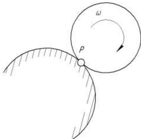
тела, касающаяся неподвижной поверхности (рис.23) имеет в данный момент времени скорость, равную нулю ( $V_P = 0$ ), и, следовательно, является мгновенным центром скоростей. Примером служит качения колеса по рельсу.
